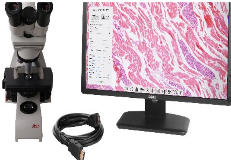
图 7-1RY804K系列相机通过 HDMI 线连接到 HDMI 接口显示器
